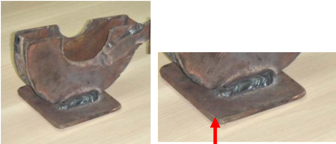
Gambar 7 : Plat besi bersaiz 6mm x 100mm x 100mm dipotong sebagai tapak komponen (1) dan (2)
