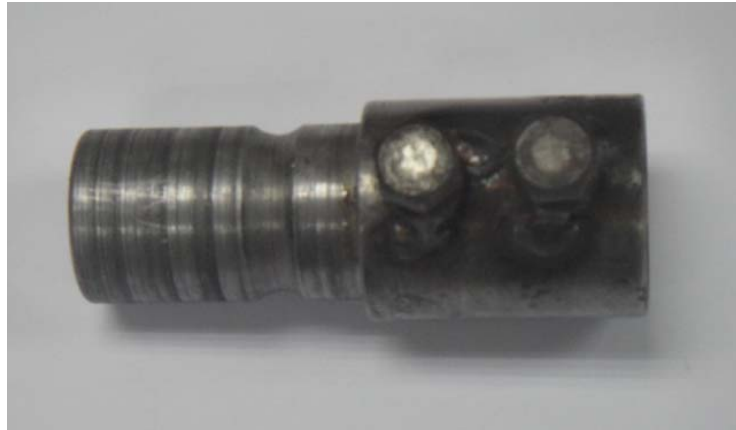
Gambar 14 : Besi padu berdiameter 30mm x 80mm dilarik bahagian luar dan dalam mengikut lukisan rekabentuk, dipasang dengan dua (2) unit bolt bersaiz 12mm untuk tujuan pengetatan kepada gandar
