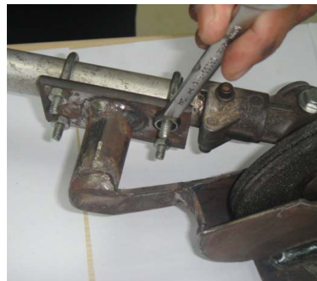
Gambar 17 : Mata pencanai dipasang ke dalam perumah (casing) serta diketatkan kepada gandar dengan tapak menggunakan U-bolt berdiameter 6mm
