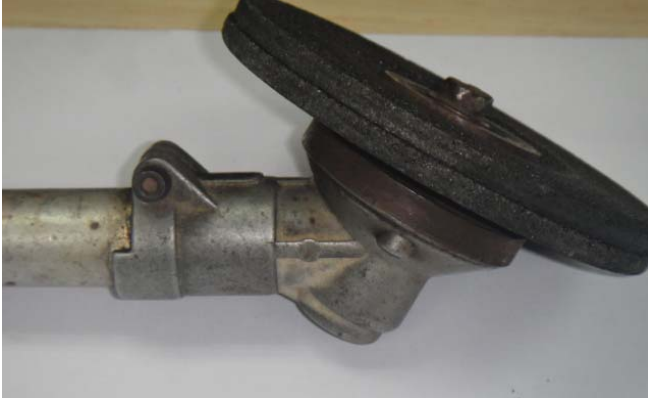
Gambar 16 : Mata pencanai di pasang pada gegancu gandar
