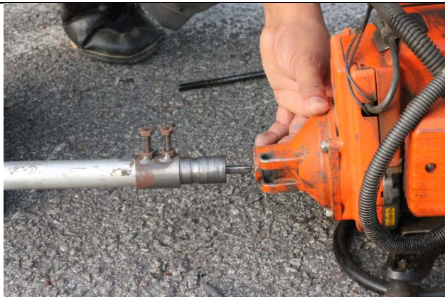
Gambar 23 : Masukkan ulu mesin Pencanai Q-1
