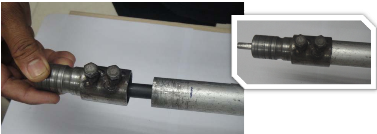
Gambar 19 : Besi penyambung gandar dipasang kepada gandar, diketatkan dengan 2 unit bolt-nut
