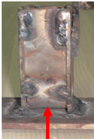
Gambar 6 : Sekeping plat besi setebal 3mm dipotong sepanjang 25mm, dilengkungkan separa bulatan bagi menyambung 2 keping plat
