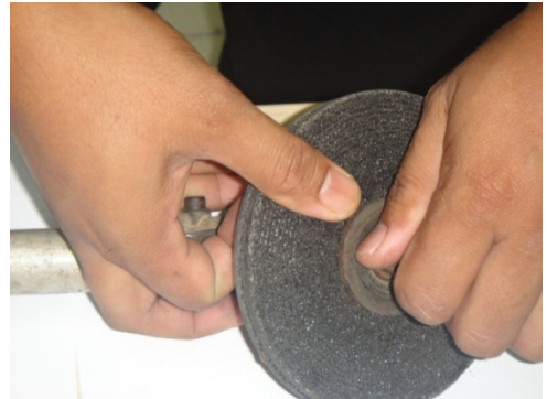
Gambar 16 : Mata pencanai di pasang pada gegancu gandar
