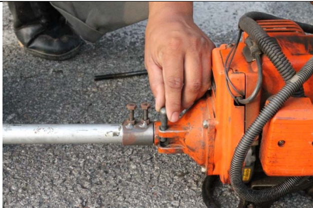
Gambar 24 : Masukkan pin dan kemaskan pada mesin rumput.
