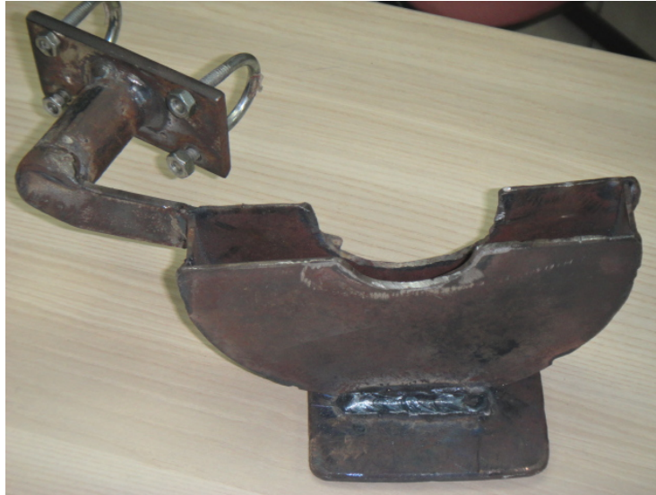
Gambar 11 : Semua komponen di Langkah 1 – 7 dipateri mengikut lukisan rekbentuk membentuk perumah (casing) bagi mata pencanai
