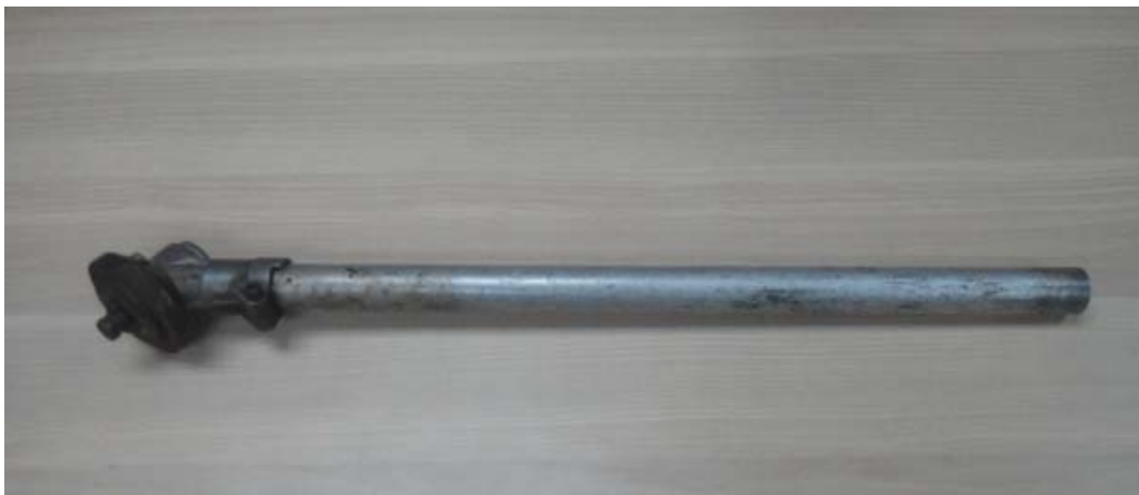
Gambar 12 : Gandar mesin rumput terpakai dipotong sepanjang 480mm
