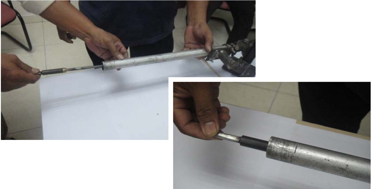
Gambar 18 : 'Shaft' dimasukkan ke dalam gandar
