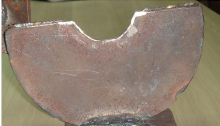
Gambar 5 : Dua (2) keping plat besi, berketebalan 3mm dipotong separuh bulatan mengikut lukisan rekabentuk
