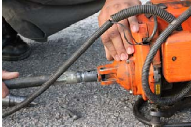
Gambar 22: Cabutkan gandar dari mesin rumput.
