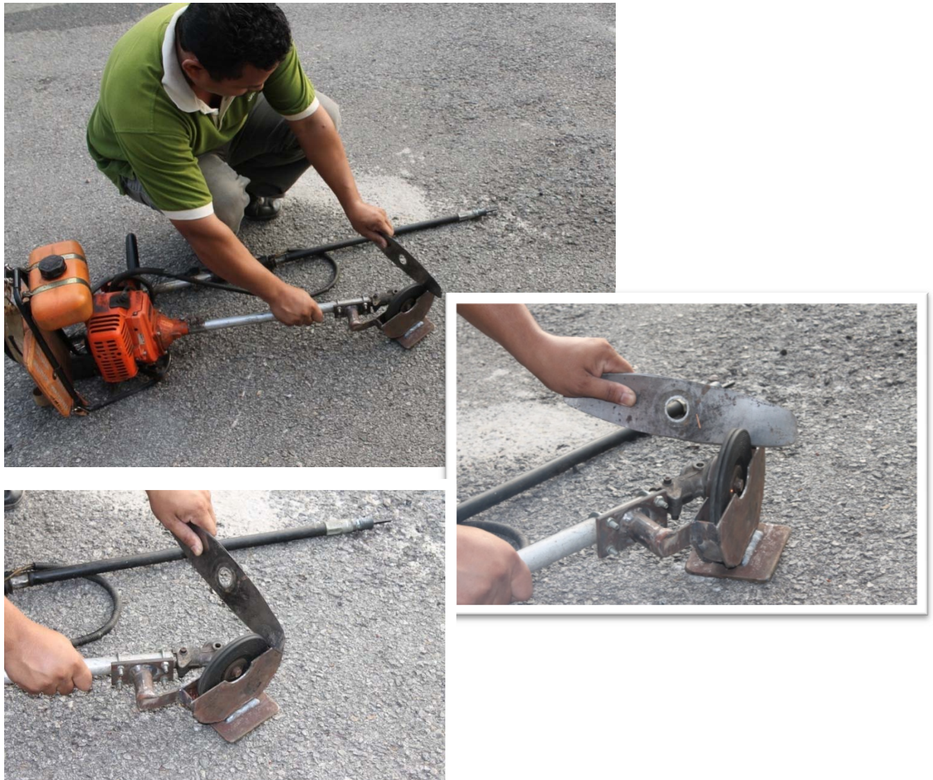
Gambar 28 : Mesin Pencanai Q-1 diujicuba untuk mengasah mata mesin rumput di luar pejabat
